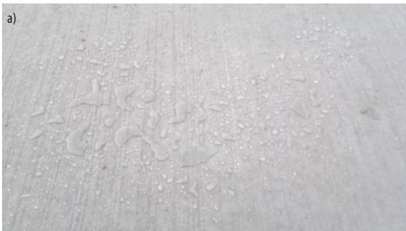
Rys. 3. Efekt działania silanowego impregnatu hydrofobizującego EuroCret HMX naniesionego na nawierzchnię lotniskową: a) efekt perlenia wody, b) fragment przekroju odwiertu rdzeniowego pobranego z zaimpregnowanej nawierzchni
