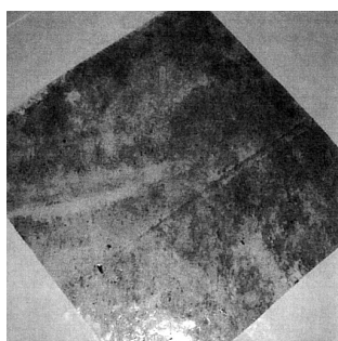
Fot. 3. Nalot organiczny na powłoce polimerowej
